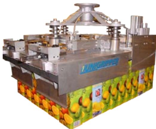
contiene las excepcionales válvulas patentadas. El repuesto principal de cada UniGripper es la espuma. La sencillez de la mantención de la espuma es garantizada gracias a la placa portadora de espuma, la
