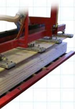
Gracias a las válvulas patentadas y su naturaleza, todos los UniGrippers son los únicos grippers de vacío que se pueden usar de forma segura en mesas giratorias.
