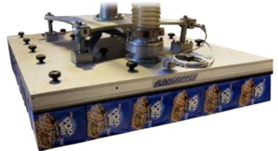
Casi todos los LayerGrippers están equipados con el floating attachment, y, dependiendo de los productos a manipular, soporte lateral con o sin faldones.
